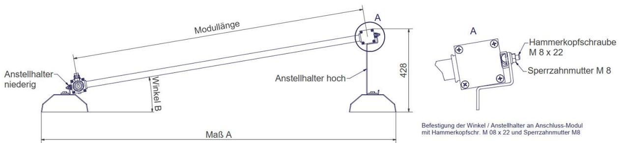
Befestigung der Winkel / Anstellhalter an Anschluss-Modul mit Hammerkopfschr. M 08 x 22 und Sperrzahnmutter M8
